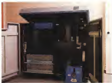
Questo è l'interno di un juke box CD-ROM da cui viene estratto il CD in grado di contenere 2 Gigabyte di dati, in un juke box come questo c'è spazio per 17 dischi.
